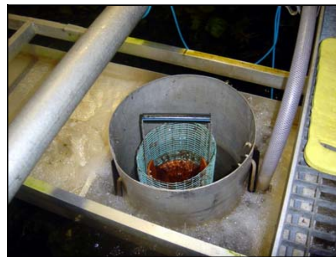
Figur 8. Øverst til høyre: Røret som sikrer minste-vannføring i elven ut fra Øvredalsvatnet i perioder uten overløp. Midten til høyre: Utløpet av Øvredalsvatnet er periodevis tørrlagt. Nede til høyre: Rister på avløp i alle kar hindre fisk i å rømme. Til venstre oppe og nede: Lønningdalselven ved slipp av minstevannføring (9.august 2006).
