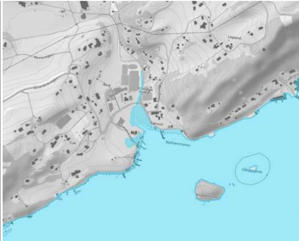
Figur 15: Kart som viser overfløymd areal i 2090 med 20- års gjentaksintervall for stormflo. (Kjelde: Statens kartverk)
