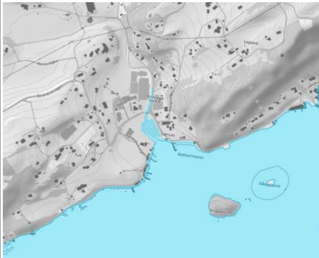
Figur 16: Kart som viser overfløymd areal i 2019 med 200- års gjentaksintervall for stormflo. (Kjelde: Statens kartverk)
