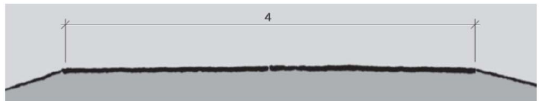
Figur C.23: Tverrprofil A3, 4 m vegbredde (mål i m)
