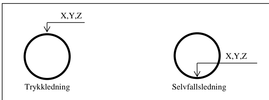
Figur 1. Måling av ledningshøyde.
